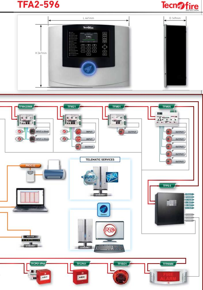
Centrali indirizzate - Addressable fire alarm panels - Systèmes d'alarme incendie adressables - Sistemas de incendio direccionables
