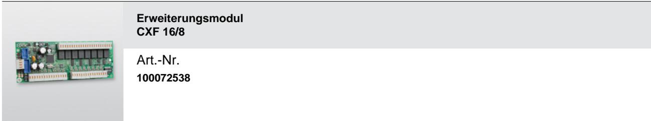
Das Erweiterungsmodul CXF erweitert die Übertragungseinrichtungen comXline 1516, 2516 und 3516 um 16 Meldelinieneingänge und 8 Fernschaltrelaisausgänge. Eine CXF-Platine lässt sich direkt auf die ÜE-Platine aufstecken. Weitere 11 Erweiterungsmodule diesen Typs können über den com2BUS bis zu 1000 m von der Übertragungseinrichtung abgesetzt werden.
